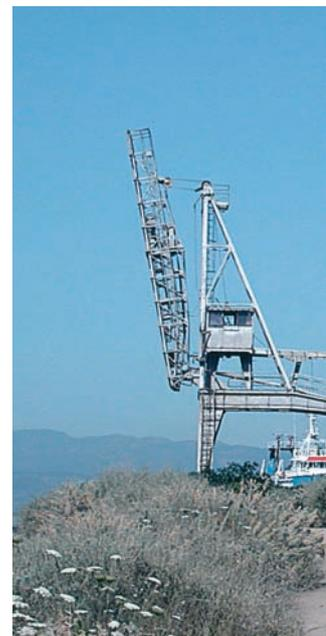
d'acciaio lunghi 150 m., motorizzati elettricamente con catene che li facevano ruotare. Il sale dalla ruspa andava sul trasportatore a nastro, che lo conduceva alle norie per il carico sui vagoni della *decauville*. Negli anni ottanta vennero introdotti gli impianti di prelavaggio anche nella fase di raccolta.
